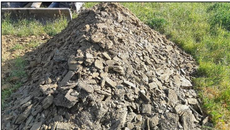
Photo 9 - Schiste avec débit en plaquettes (sondage 3)
